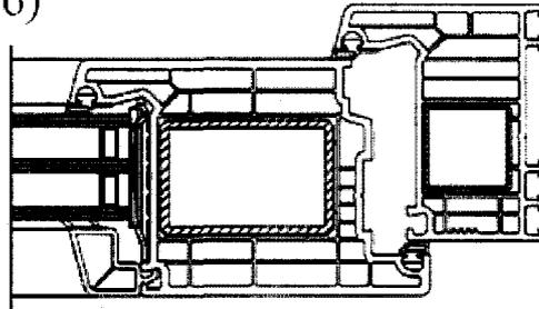
а) дверная система с тремя контурами уплотнения; б) дверная система с двумя контурами уплотнения
