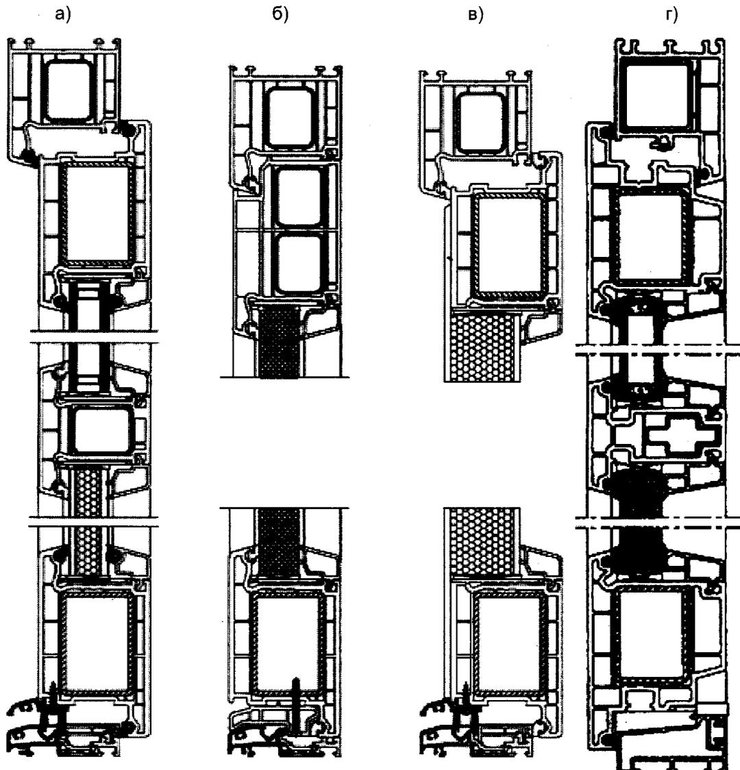
а – заполнение верхней части полотна стеклопакетом и нижней части трехслойной панелью;
