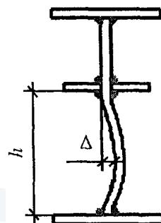
12. Выпучивание стенки балок и коробок при свободной высоте стенки  $h$
