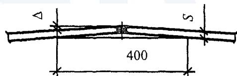
13. Остаточные угловые деформации в сварных стыковых соединениях ("домики"), определяемые стрелой прогиба Дельта на базе 400 мм при толщине  $S$  стыкуемых листов, мм:
