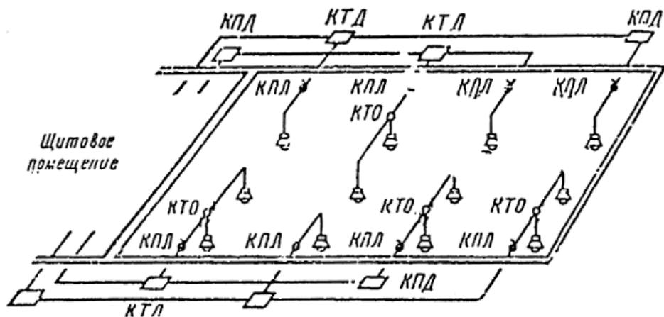
Рис. 27. Вариант выполнения разводки трубопроводов осветительной сети в помещении класса В-І.
