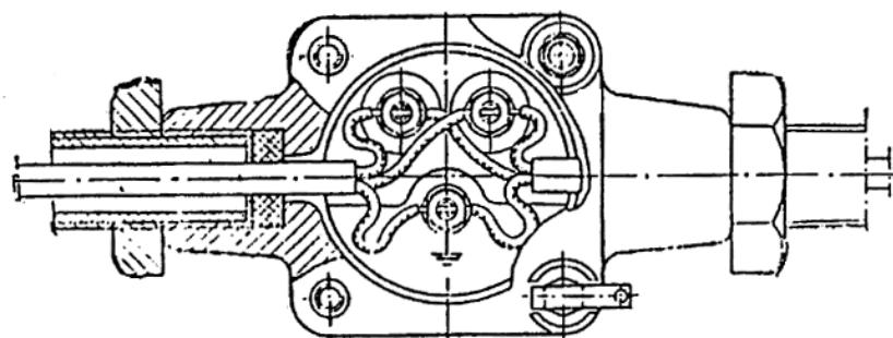
Рис. 91. Подключение кабелей в вводных устройствах светильников В3Г-100 и В4А-60.
