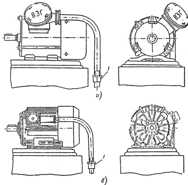
Рис. 73. Подвод труб к электродвигателям серии ВАО.
