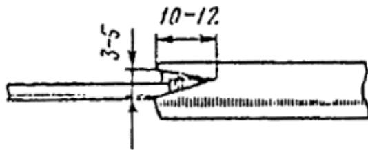
Рис. 47. Подготовка конца жилы к герметизации.
