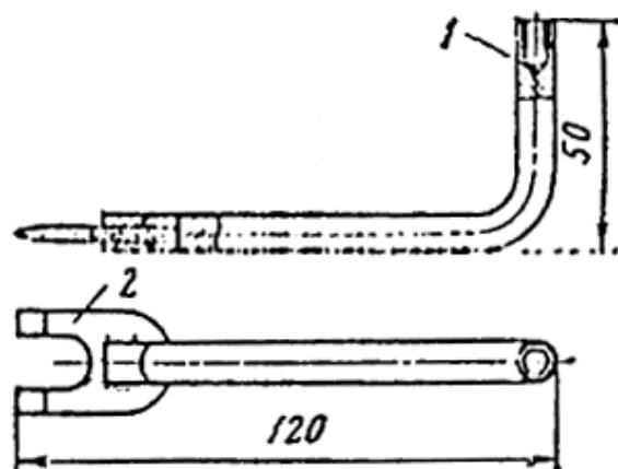
Рис. 96. Ключ для монтажа светильников ВЗГ-200А и ВЗГ/В4А-200.
