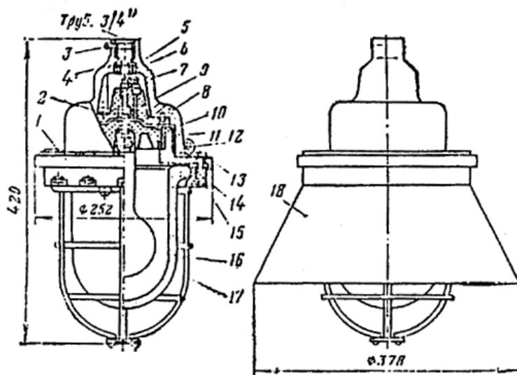
Рис. 94. Светильник взрывонепроницаемый В3Г/В4А-200.
