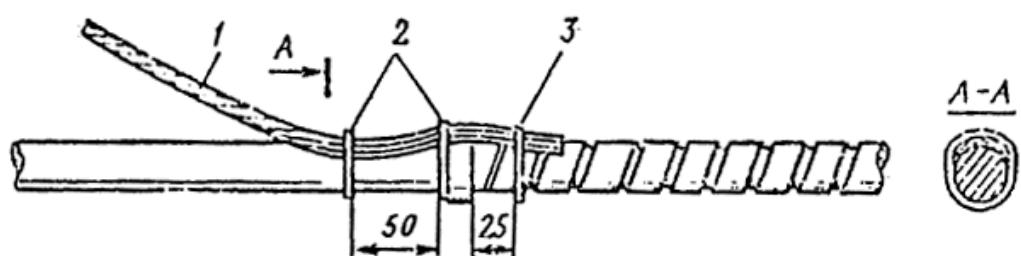
Рис. 42. Закрепление заземляющего проводника на кабеле.
