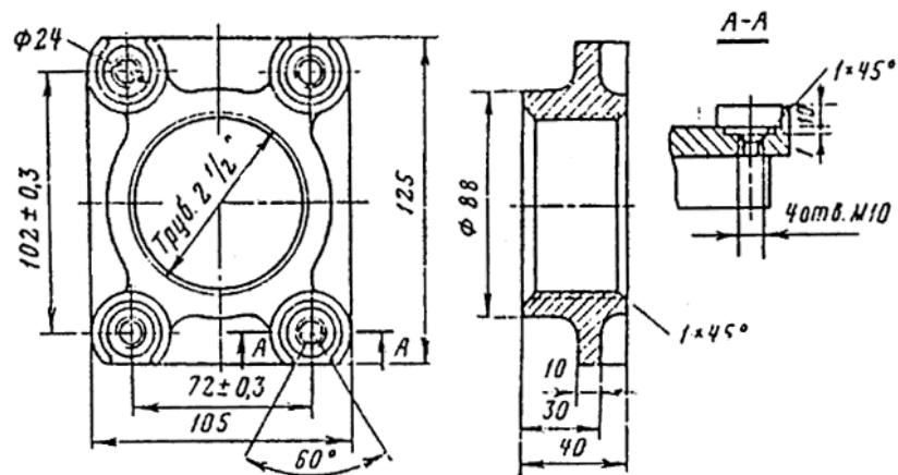
Рис. 61. Нажимная муфта вводных устройств К-4, К-6.
