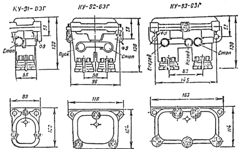
Рис. П9-3. Посты управления взрывонепроницаемые КУ-90-В3Г.
