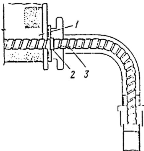
Рис. 41. Примерка кабеля и наложение бандажа.
