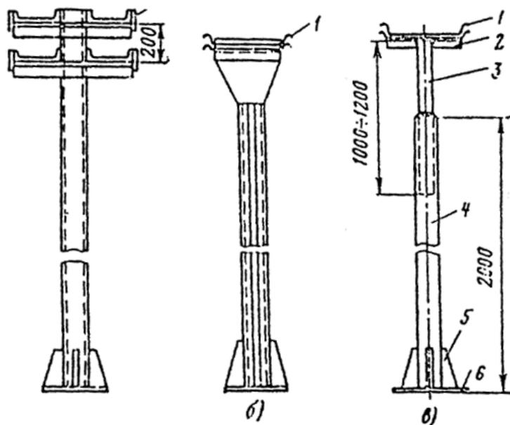
Рис. 5. Примеры стоек для установки лотков.
