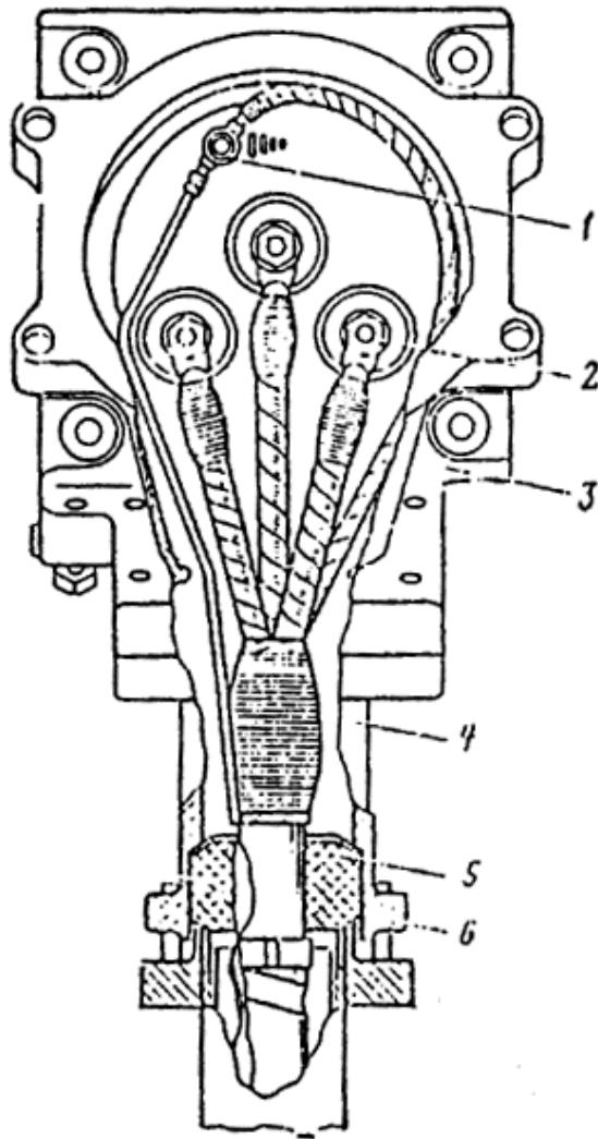
Рис. 67. Общий вид смонтированного вводного устройства (без крышки) электродвигателей БАО 4 — 9-го габаритов.
