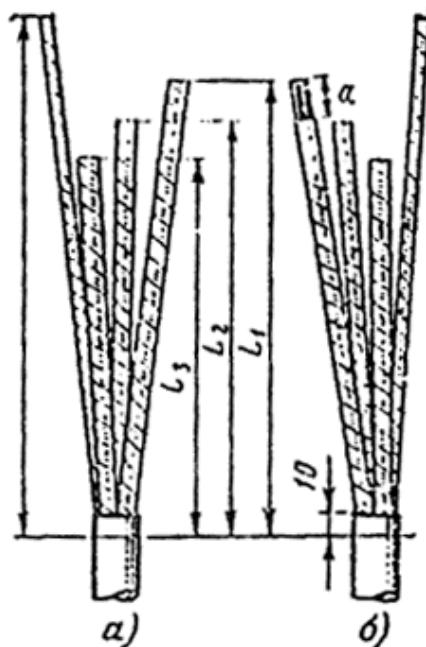
Рис. 72. Длина жил при подготовке кабелей к заделке для электродвигателей серии ВАО 316 — 460-го габаритов и серии МАЗ6 6 — 7-го габаритов.
