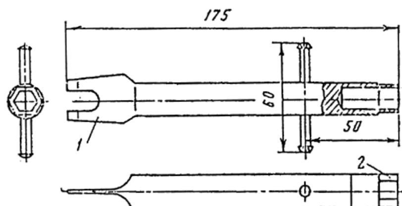
Рис. 97. Ключ для светильника Н4Б-300.
