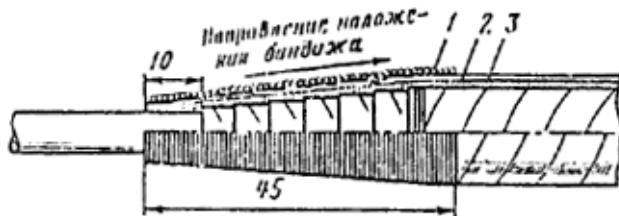
Рис. 55. Герметизация однопроволочной жилы.
