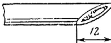
Рис. 46. Подготовка конца трубы из поливинилхлоридного пластика (со стороны корешка) для надевания на жилы.
