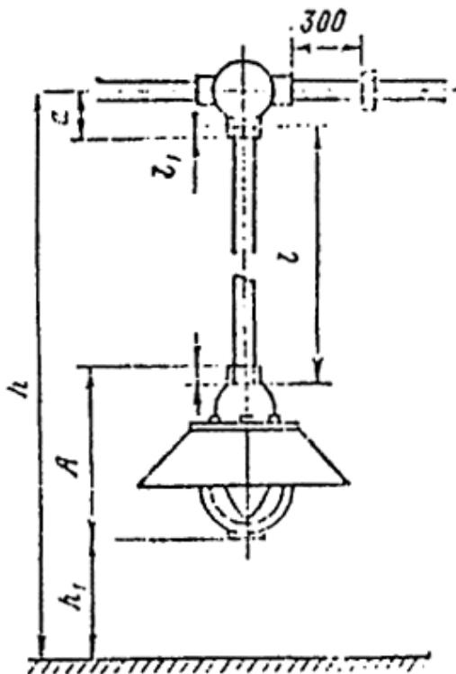
Рис. 103. Прямой спуск к светильнику.
