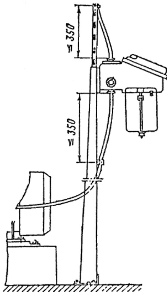
Рис. 81. Подвод кабелей марки ВБВ (АВБВ) пускателю серии ПМ-702, установленному на стойках.
