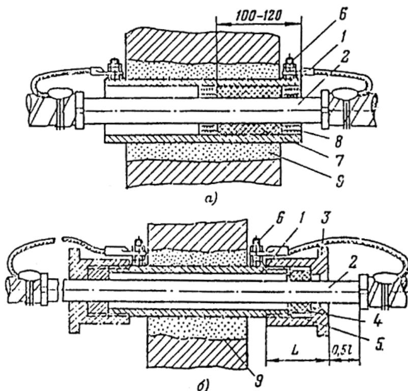
Рис. II. Проходы кабелей сквозь внутренние стены помещений.
