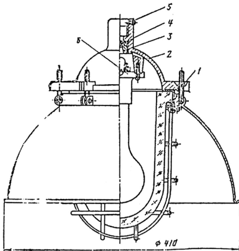
Рис. 95. Светильник повышенной надежности против взрыва типа Н4Б-300.
