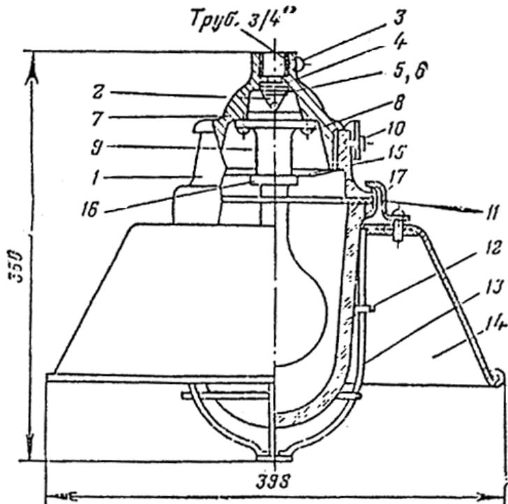
Рис. 93. Светильник взрывонепроницаемого исполнения В3Г-200А.
