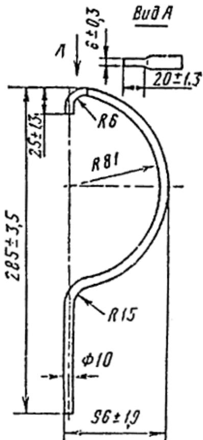
Рис. 90. Ключ для снятия кольца с колпаком и сеткой у светильников В3Г-100 и В4А-60.
