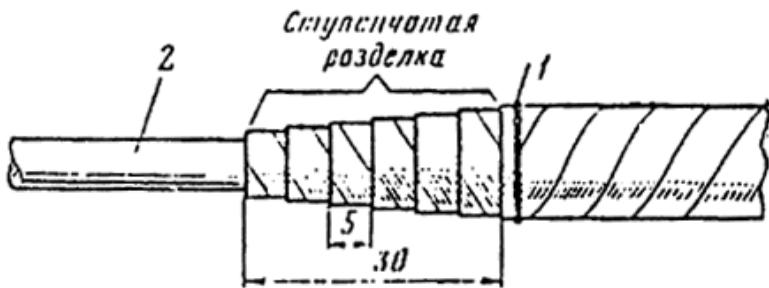
Рис. 54. Снятие изоляции с конца однопроволочной жилы.
