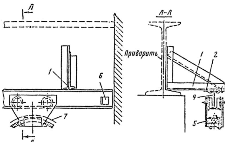
Рис. 106. Крепление двутавровой балки к подкрановому пути.
