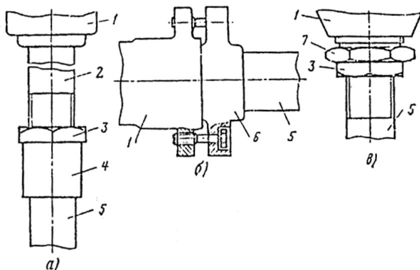
Рис. 26. Варианты разъемных присоединений трубопроводов к электрооборудованию.
