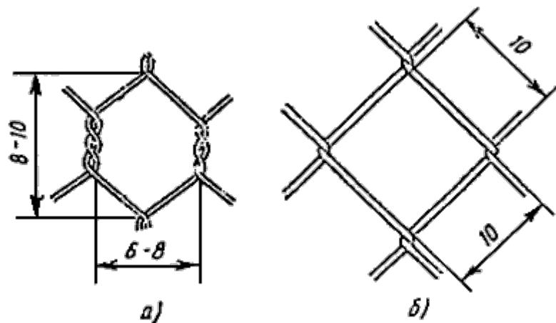
Рис.1. Деталь скрутки сетки габиона:
