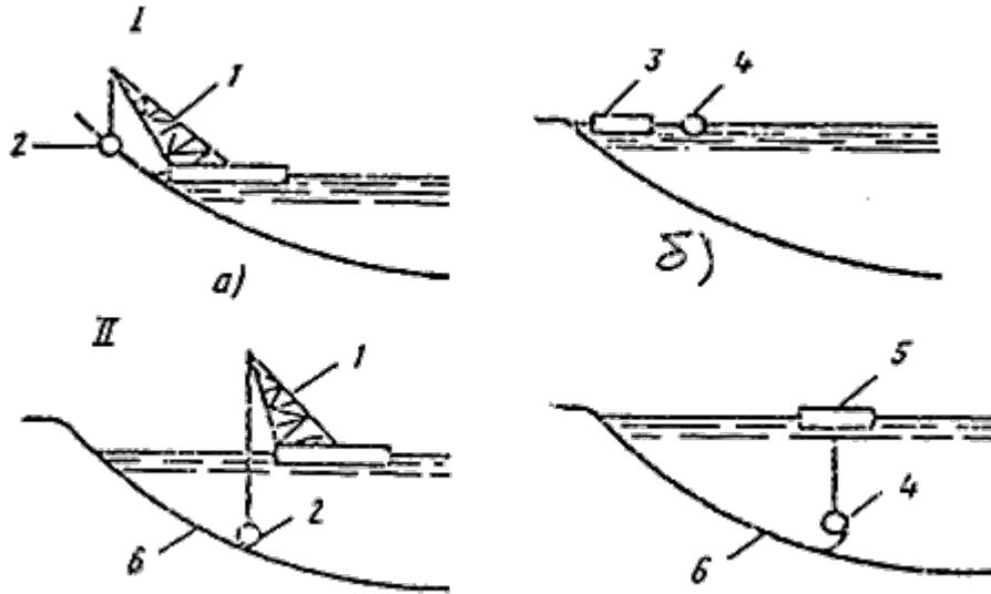
Рис.3. Схема работ по намотке и укладке карт покрытия:
