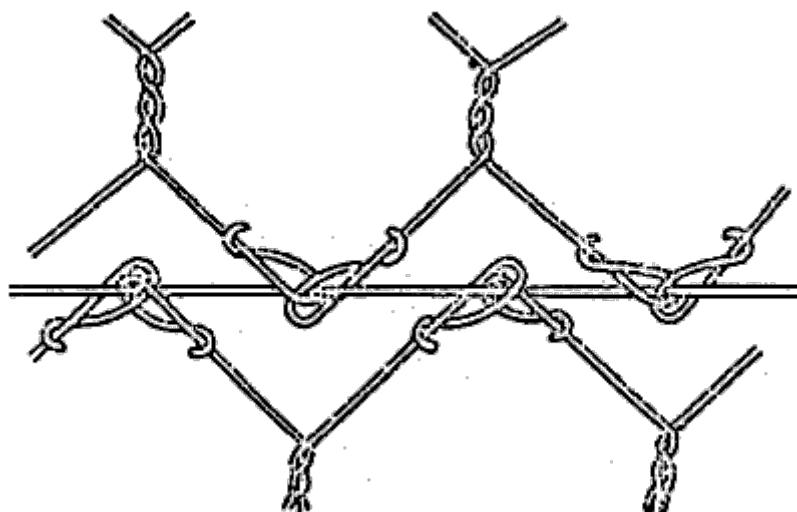
Рис.2. Прикрепление сетки к каркасу
